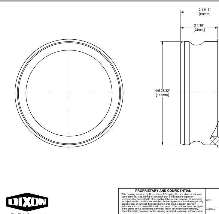
DIXON C U.S.A. THE RIGHT CONNECTION ™ 5" DIXON™ / BOSS-LOCK™ ADAPTER x SOCKET TO PIPE CAM AND GROOVE FITTING
